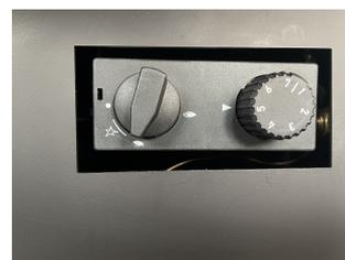
> Hebel weiter nach rechts zum großen Flammensymbol drehen, anschließend mit dem rechten Stellrad die gewünschte Brennstärke einstellen.
